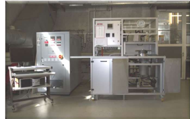
Autoclave scCO 2 , P_{\text{max}} 300 bar, T_{\text{max}} 300 ° C
